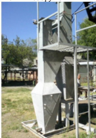
Рис. 1. Фазовый сепаратор загрязнений сточных вод
